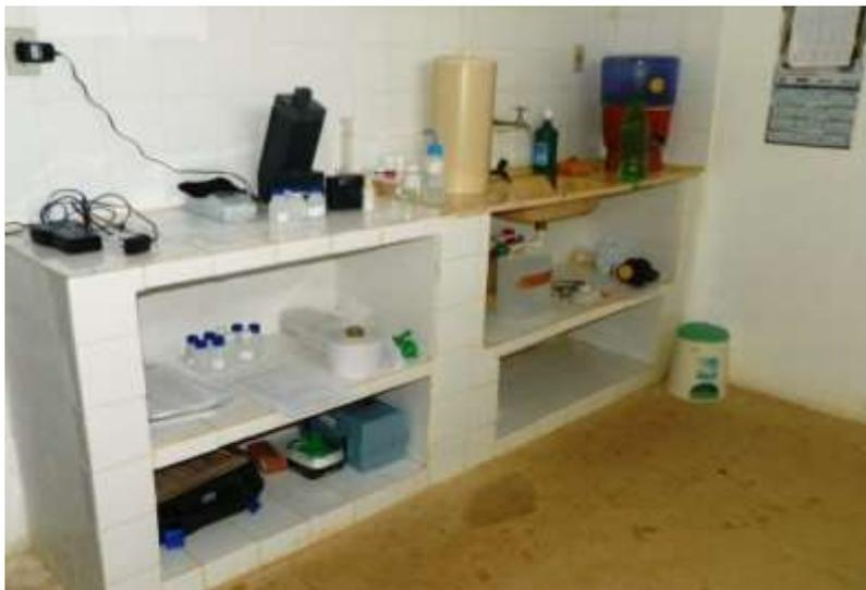
**Figura 7.7** – Vista dos equipamentos pHmetro, turbidímetro e colorímetro existentes na Casa de Química / Laboratório localizados na ETA da sede de Altaneira.
