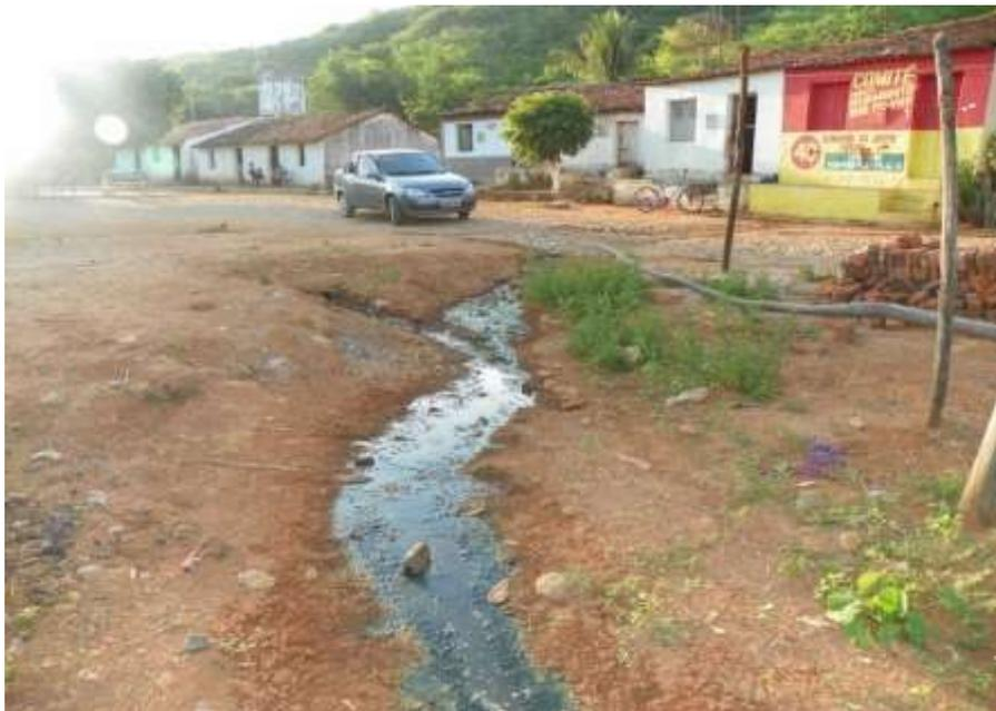
**Figura 7.38** – Imagem típica de lançamento de esgoto a céu aberto no distrito de São Romão.
