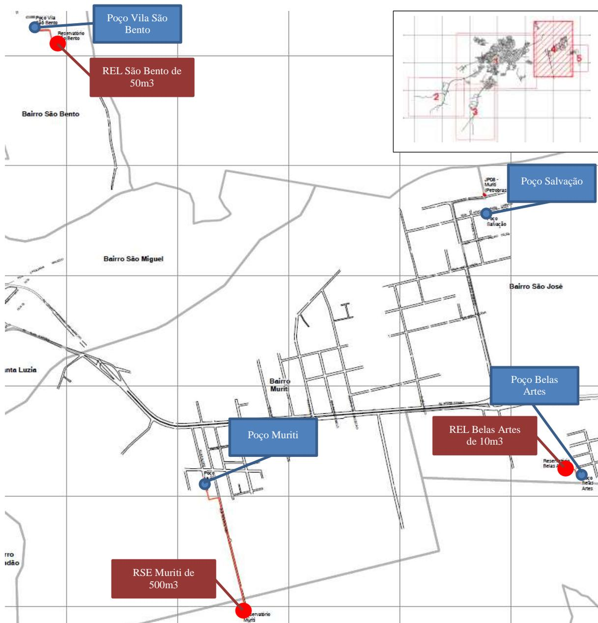
**Figura 7.7 – Croqui do sistema de abastecimento de água da sede do Crato.**
