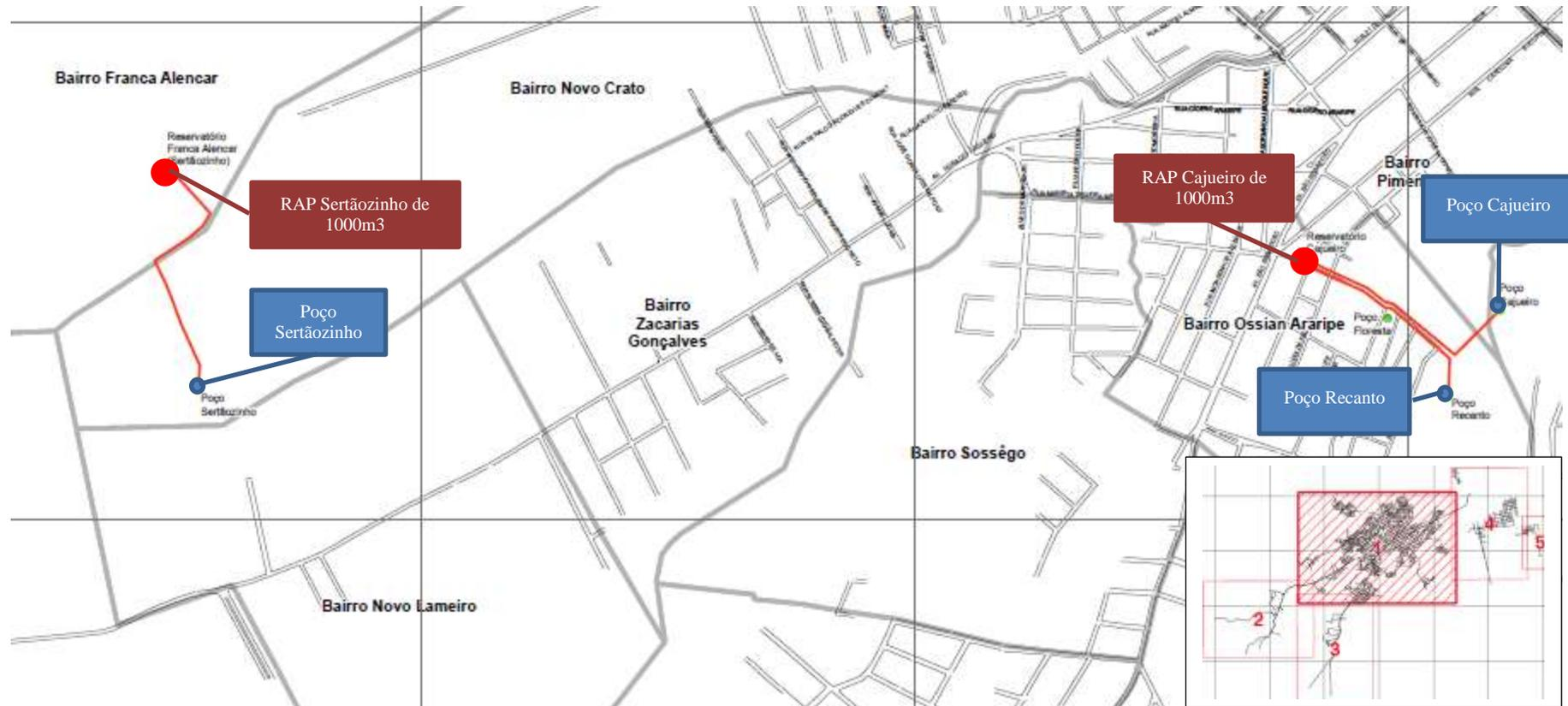
**Figura 7.3** – Croqui do sistema de abastecimento de água da sede do Crato.
