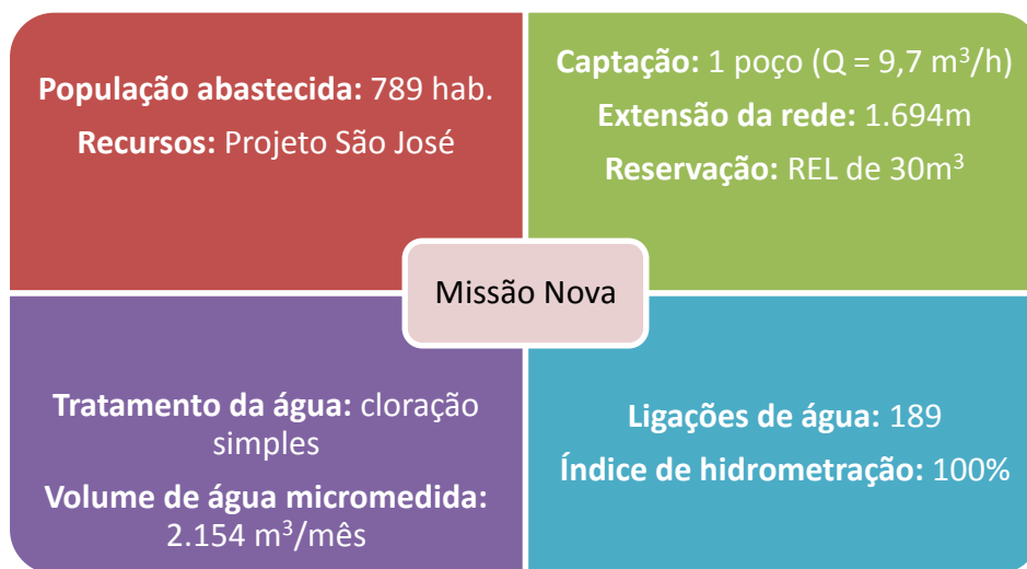
Figura 7.24 – Dados sobre o abastecimento de água do distrito de Missão Nova, no município de Missão Velha, de responsabilidade do SISAR.
