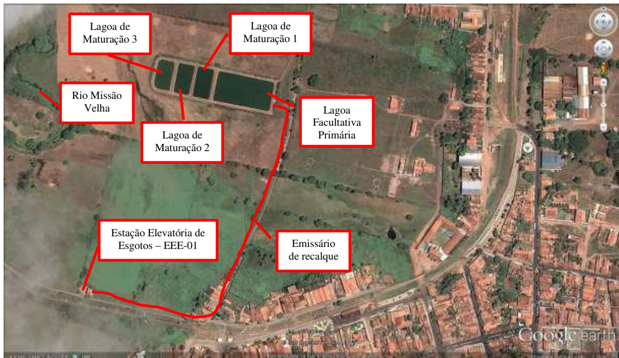
Figura 7.77 – Localização da Estação Elevatória de Esgotos (EEE-01) em relação à ETE de Missão Velha, assim como do emissário de recalque.
