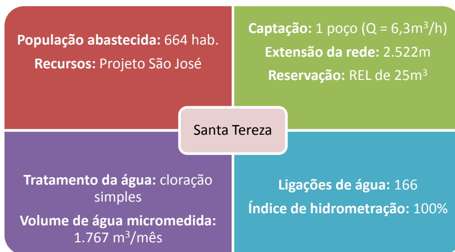
Figura 7.39 – Dados sobre o abastecimento de água da localidade de Santa Tereza, no município de Missão Velha, de responsabilidade do SISAR.
