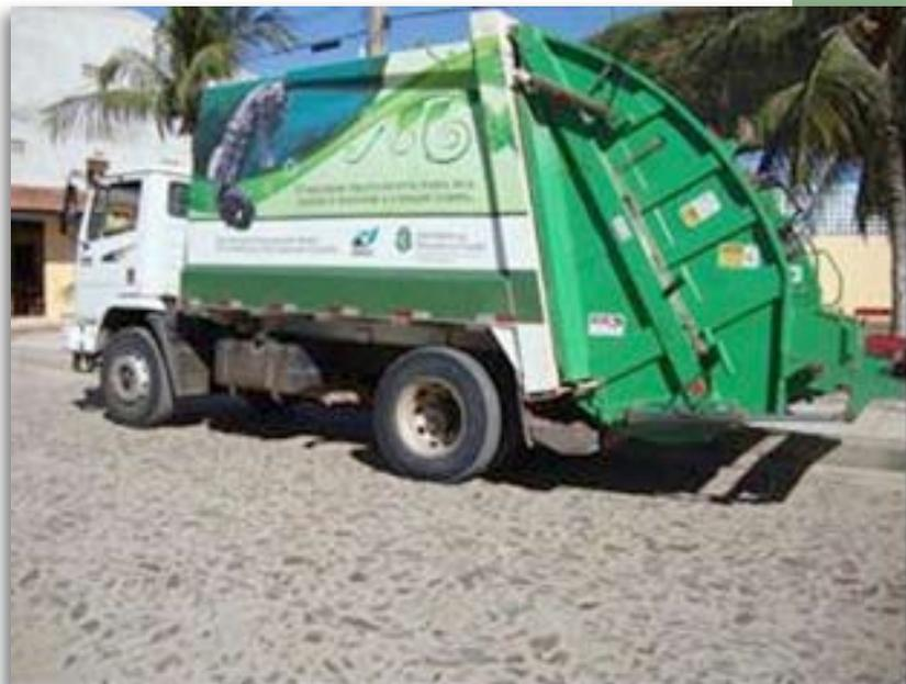
**Figura 6** - Veículo de compactados para coleta de resíduos
