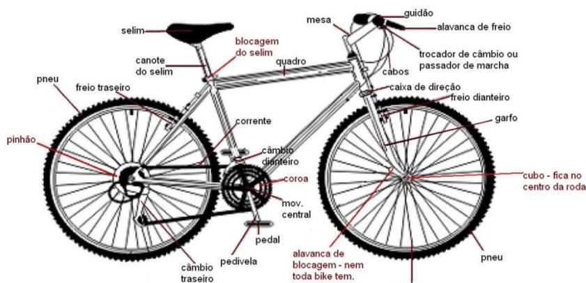
Figura 22 Componentes da Bicicleta. Fonte: Comer, Rezar e Pedalar, s.d.
