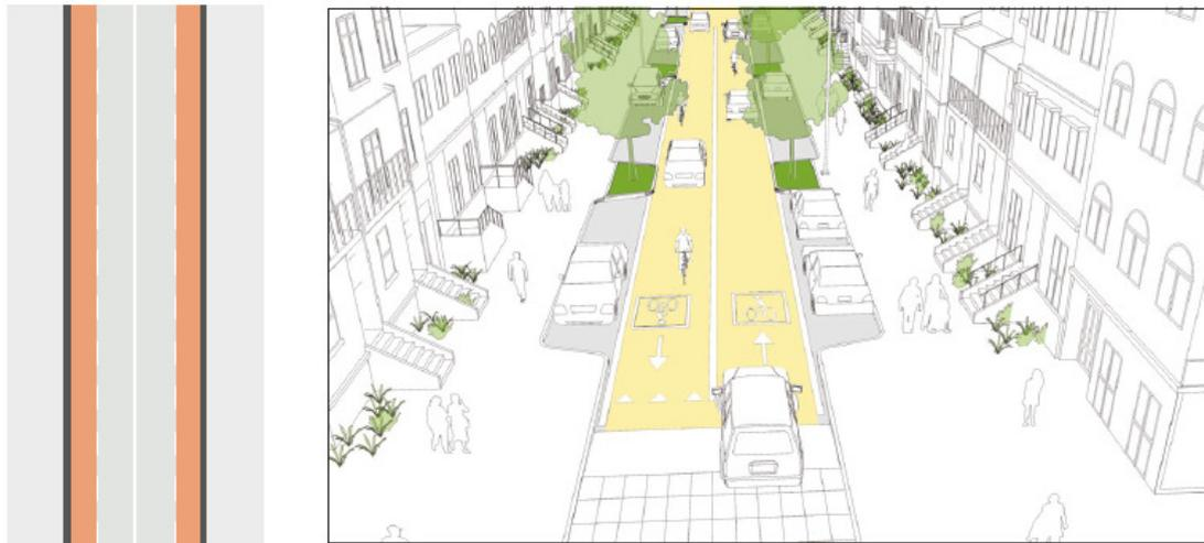
Figura 12 O estreitamento da via reduz a velocidade e proporciona mais espaço para pedestres. Fonte: Nacto.
