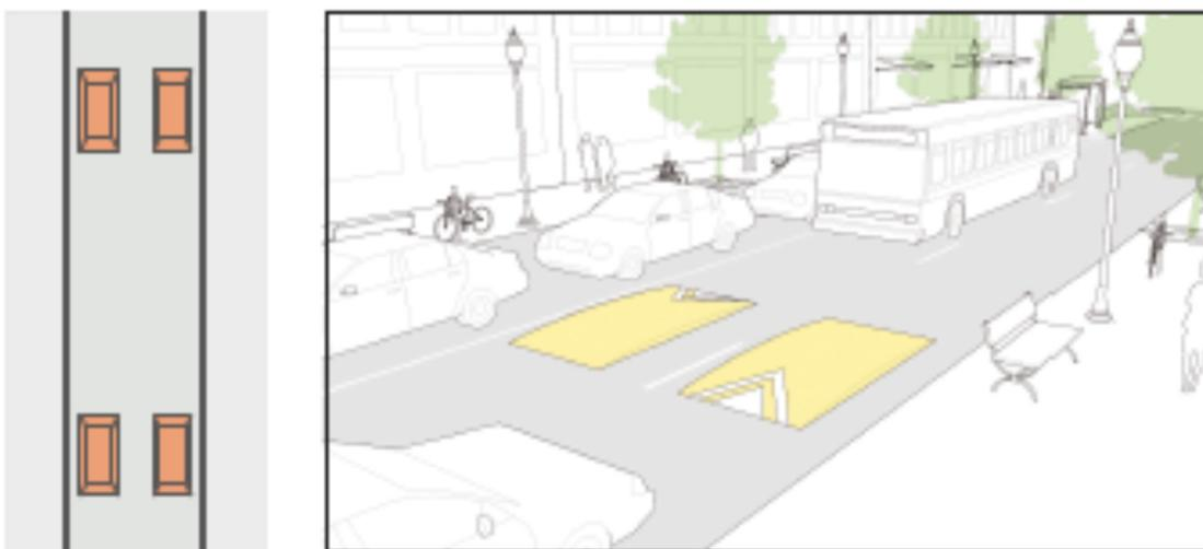
Figura 19 Exemplo de lombadas descontínuas. Fonte: Nacto.
