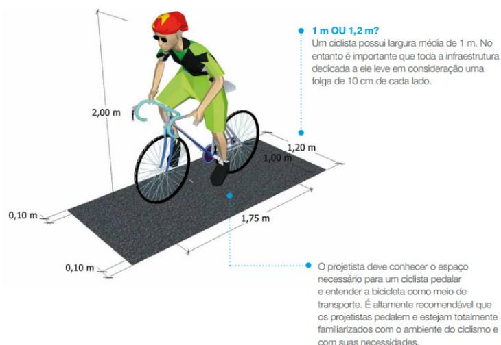
Figura 23 Dimensões básica do ciclista na bicicleta. Fonte: EMBARQ.
