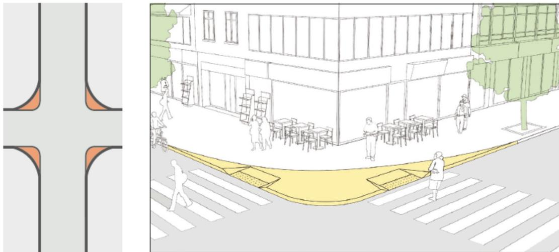
Figura 13 Exemplo de intervenção da redução do raio de giro. Fonte: Nacto.
