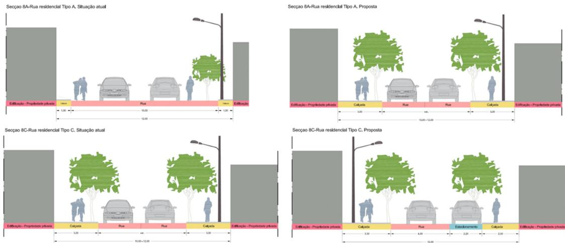
Figura 6 Proposta de modificação da seção para melhorar a largura das calçadas. Caixas de 12 metros
