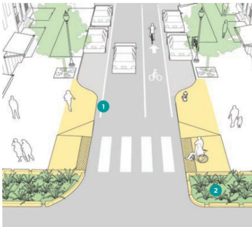
Figura 8 Faixa de pedestres acessível e com visibilidade. Eliminação de uma vaga de estacionamento para melhorar a visibilidade. Fonte: Urban Street Design Guide. National Association of City Transportation Officials
