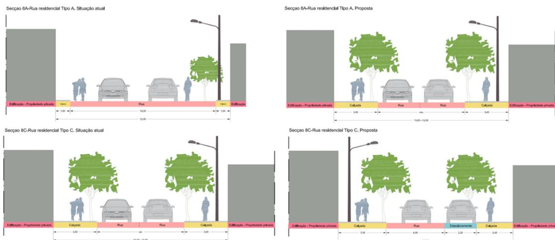
Figura 7 Proposta de modificação da seção para melhorar a largura das calçadas. Caixas de 12 metros
