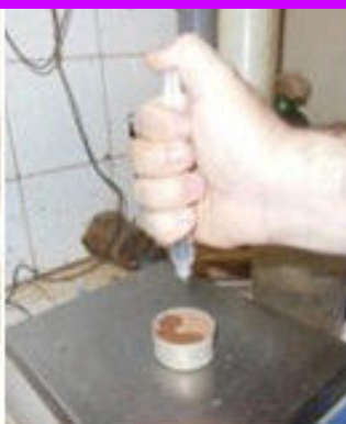
Detalhamento da seqüência do ensaio de imprimação pelo Método da Cápsula
