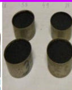
Detalhamento da seqüência do ensaio de imprimação pelo Método da Cápsula
