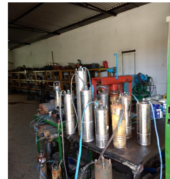
Bombas Submersas dos Poços em Manutenção
