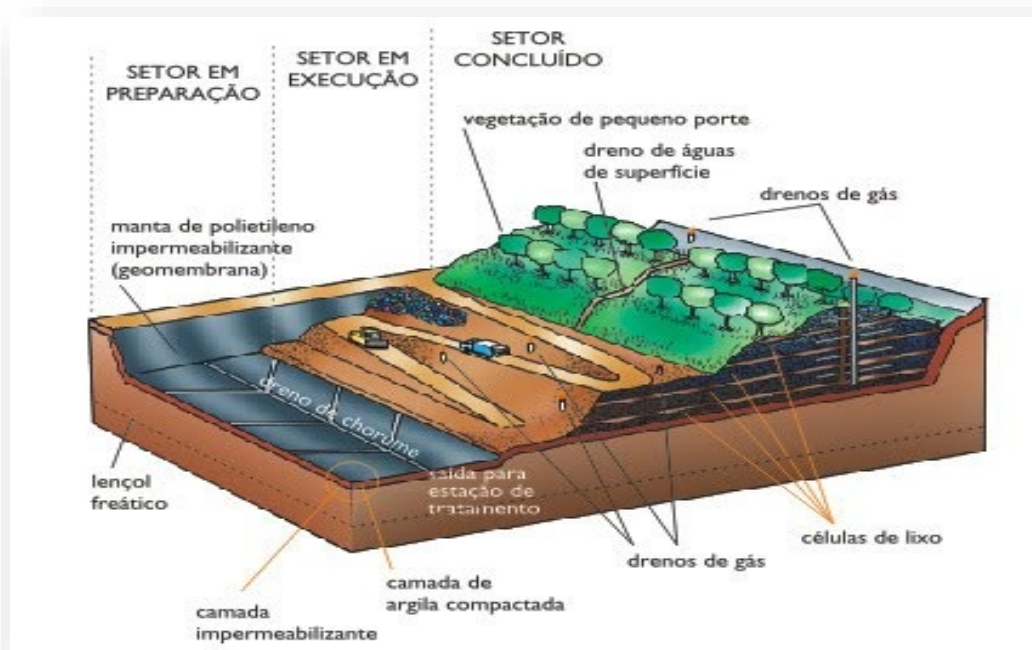
Figura 72 Setorização do Aterro Sanitário
