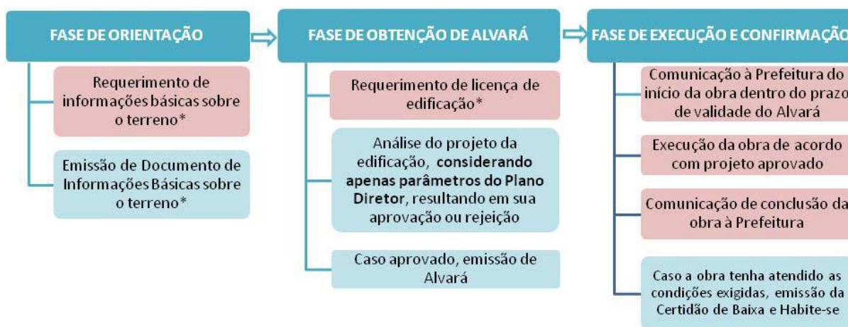
Figura 9 – Tipo 1: Procedimentos de licenciamento de edificações de uso residencial com até 250 m 2 e no máximo 4 unidades habitacionais
