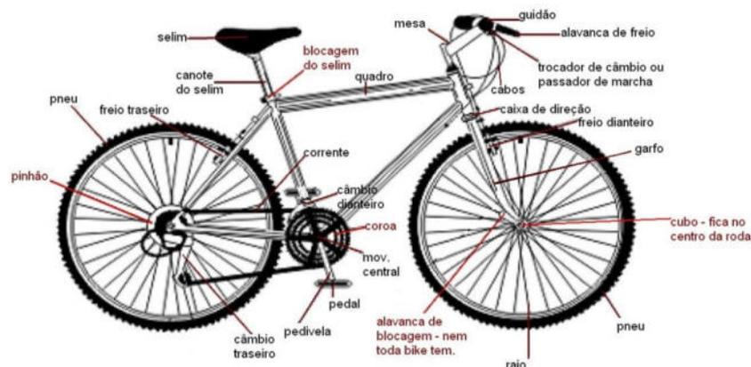
Figura 23 Componentes da Bicicleta. Fonte: Comer, Rezar e Pedalar, s.d.
