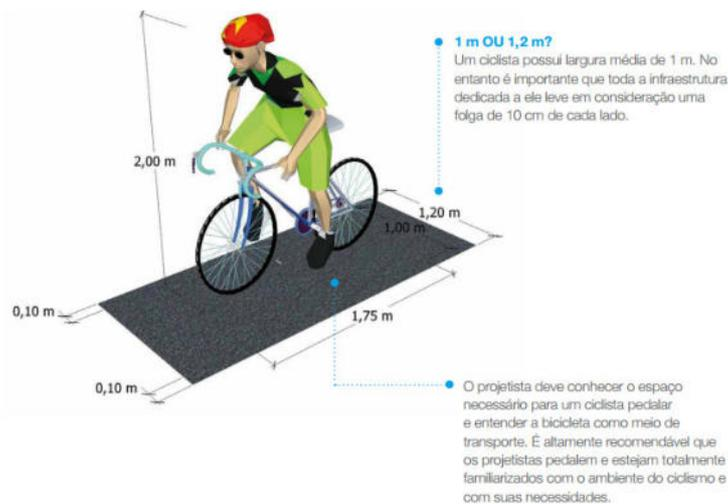
Figura 24 Dimensões básica do ciclista na bicicleta. Fonte: EMBARQ.
