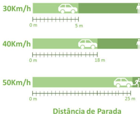
Figura 10 - Relação entre velocidade e a distância de parada. Distâncias mínimas de parada, incluindo a percepção de reação, e de paradas, baseada em condições ideal. Fonte: Nacto
