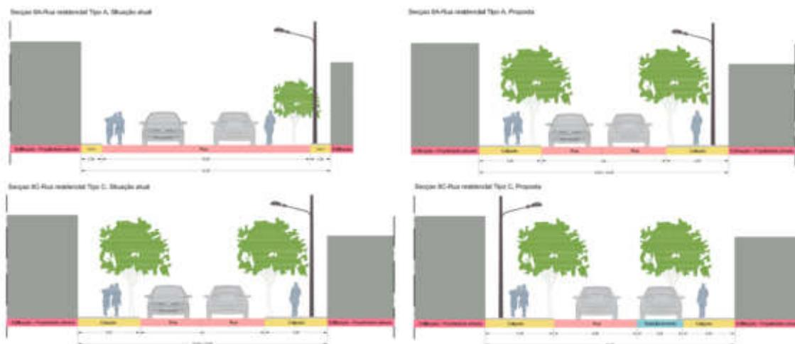
Figura 8 Proposta de modificação da seção para melhorar a largura das calçadas. Caixas de 12 metros
