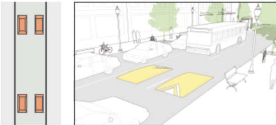
Figura 42 Exemplo de lombadas descontinuas. Fonte: Nacto.
