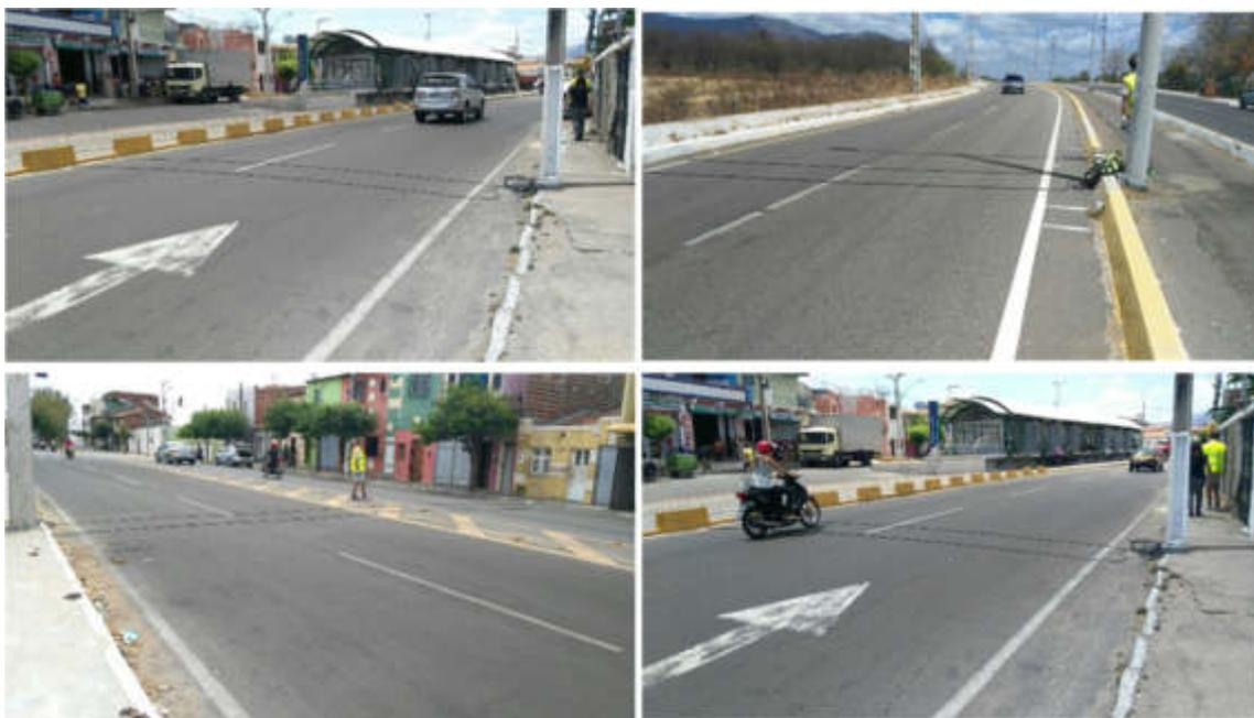
*Fotografia 15 - Equipamentos pneumáticos. Contagens volumétricas 24 horas. Fonte: Elaboração Idom*
