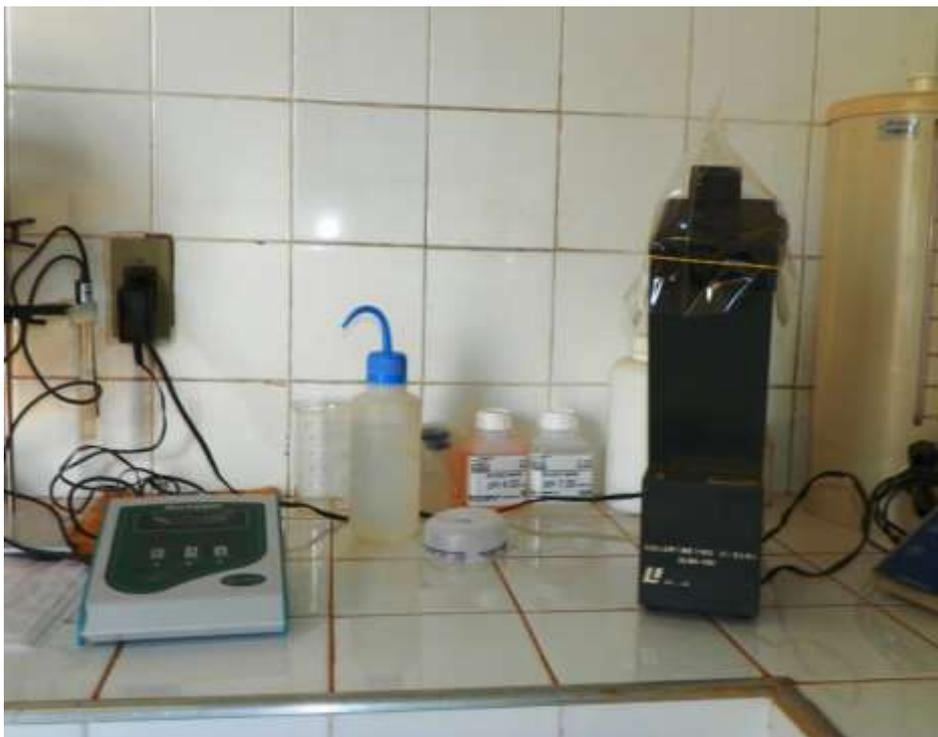
**Figura 7.13** – Vista dos equipamentos pHmetro, turbidímetro e colorímetro existentes na Casa de Química / Laboratório localizados na área do poço tubular PT-04 na sede de Barbalha.
