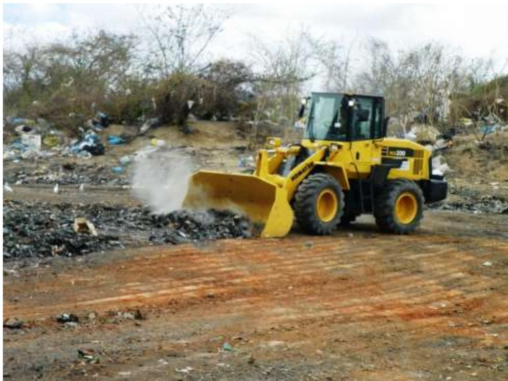
**Figura 7.70** – Vista de um dos equipamentos utilizados nas operações de abertura de vala e compactação no lixão de Barbalha.
