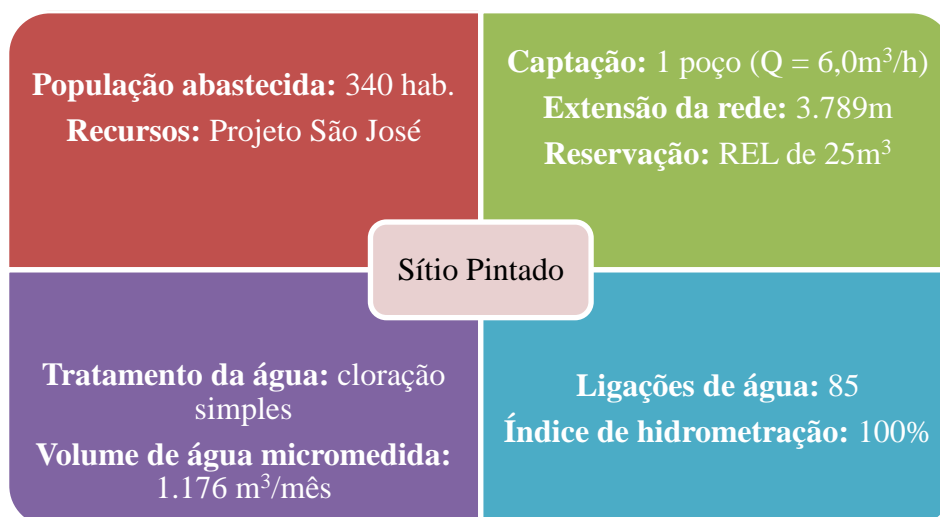
Figura 5.18 – Dados sobre o abastecimento de água da localidade de Sítio Pintado, no município de Missão Velha, de responsabilidade do SISAR. Fonte: Consórcio DGH-Cariri (2012).
