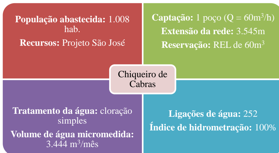
Figura 5.11 – Dados sobre o abastecimento de água da localidade de Chiqueiro de Cabras, no município de Missão Velha, de responsabilidade do SISAR. Fonte: Consórcio DGH-Cariri (2012).
