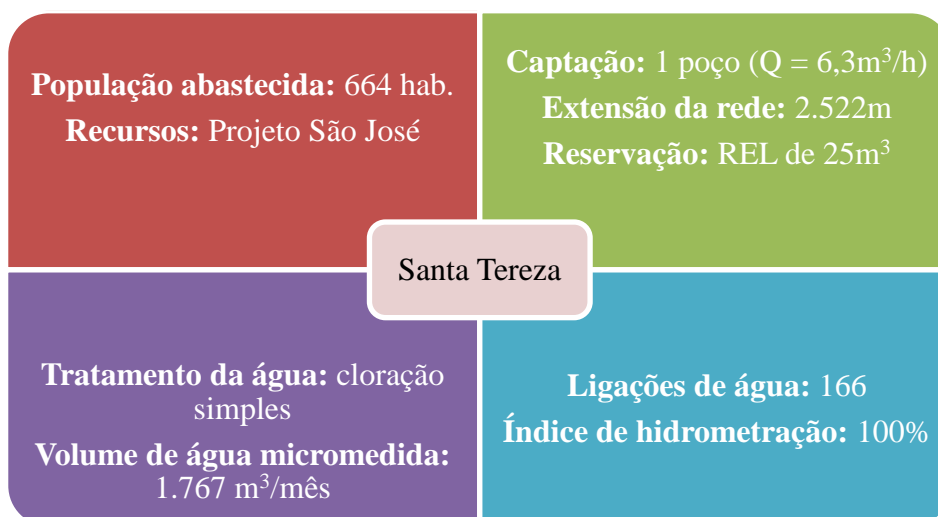
Figura 5.8 – Dados sobre o abastecimento de água da localidade de Santa Tereza, no município de Missão Velha, de responsabilidade do SISAR. Fonte: Consórcio DGH-Cariri (2012).
