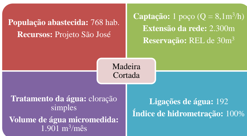
Figura 5.14 – Dados sobre o abastecimento de água da localidade de Madeira Cortada, no município de Missão Velha, de responsabilidade do SISAR. Fonte: Consórcio DGH-Cariri (2012).
