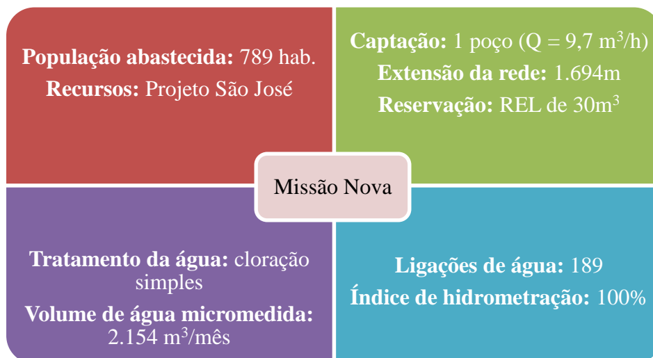
Figura 5.3 – Dados sobre o abastecimento de água do distrito de Missão Nova, no município de Missão Velha, de responsabilidade do SISAR. Fonte: Consórcio DGH-Cariri (2012).
