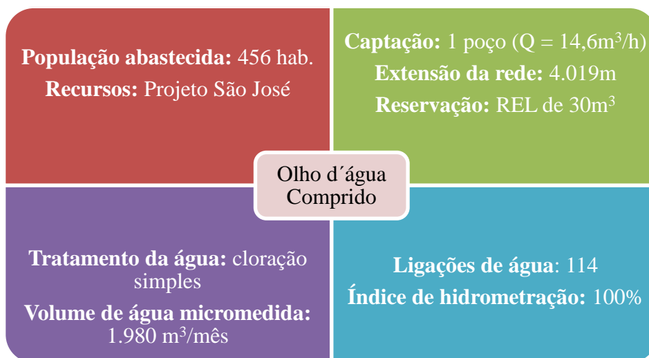
Figura 5.6 – Dados sobre o abastecimento de água da localidade de Olho d’água Comprido, no município de Missão Velha, de responsabilidade do SISAR. Fonte: Consórcio DGH-Cariri (2012).
