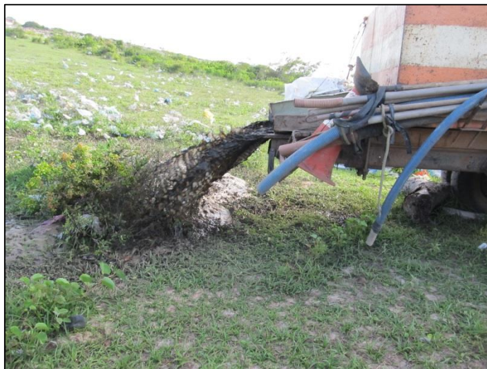
Figura 6.3 - Lançamento irregular de esgotos no solo por “limpa fossa”.
