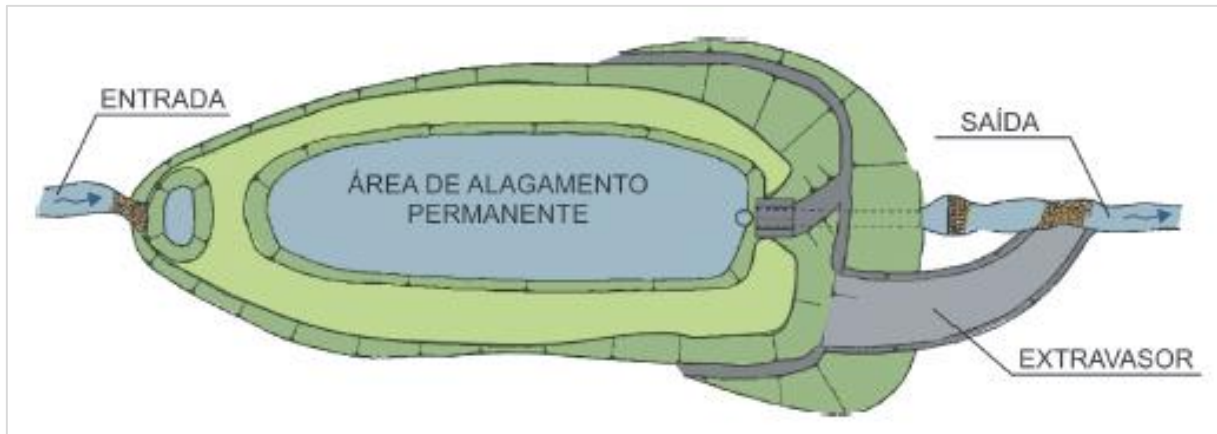
Figura 6.2 - Bacias de retenção alagadas
