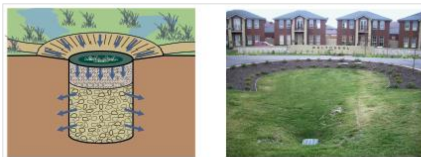
Figura 6.6 - Exemplo de poço de infiltração
